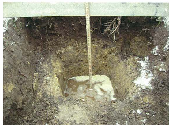
Retteskinnen bliver lagt over hullet, Tommestokken bliver sat fast. Der bliver hældt vand i hullet, for at vandmætte jorden til vandmætningstesten.
