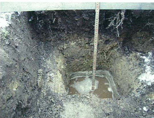
Vandet synker mindre end 20 cm på 15 minutter. Der tages vand op af hullet, så Infiltrationsprøven kan starte. Der tages mål af vandstandshøjden, og der ventes i 10 minutter for at se hvor meget vandet er sunket.
