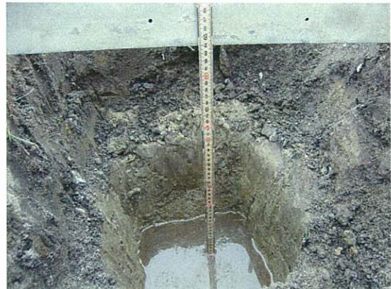
Der tages vand op af hullet, så Infiltrationsprøven kan starte. Der tages mål af vandstandshøjden, og der ventes i 10 minutter for at se hvor meget vandet er sunket.
