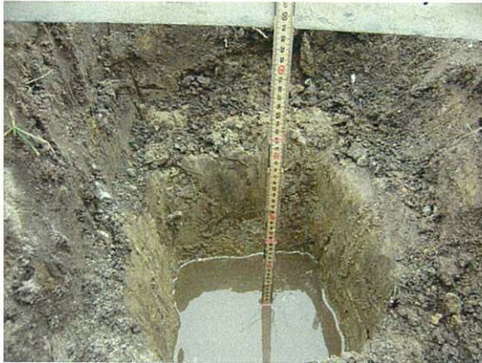
Vandet synker mindre end 20 cm på 15 minutter.
