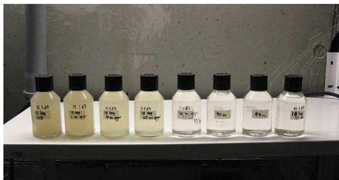
Visuelt proof of concept. Prøver af vejvand udtaget før, under og efter rensning i DPF-pilotanlægget i Ørestad. Når regnvand strømmer af fra trafikerede overflader har det en dårlig kvalitet. Flasken længst til venstre indeholder vejvand udtaget under tilstrømning til DPF-indløbsbygværket, dvs. efter passage af olieudskiller og sandfang. Vandet i de 6 midterflasker er udtaget med en tynd sugeslange (se foto) i stigende afstand fra indløbet; 1 m, 10 m, 20 m, 30 m, 40 m, og 49 m. Flasken længst til højre er det færdigtrensede vand, klar til forsyning af Ørestads kanaler. Kemiske analyser bekræfter en samtidig markant reduktion i den 'usynlige' forurening (Tabel 1).
