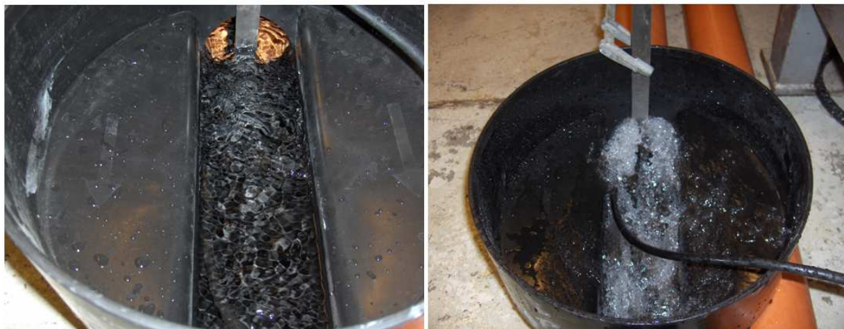
Figur 25, Fotografier fra forsøg med Flowmåler. Vandet bliver tilført (øverst i billedet) via et rør til den sorte "spand" der har samme form som bunden af flowbrønden. Vandet kan så løbe ud igen af den samme type rør i den anden ende (nederst i billedet). Billedet til venstre viser 'normale' forhold, hvor flowmåleren vil fungere som den skal. Billedet til højre viser en så stor mængde vand, at det medfører en opstuvning som kan lede til ukorrekte målinger. Foto: Niels H. Eisum
