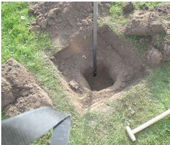
Der hældes ca. 0,05 m grus i bunden af prøvehullet.
