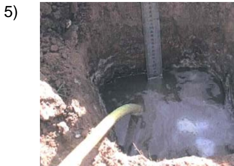
Synkehastighed måles. Hvis vandspejlet synker mindre end 20 cm på 15 min. Kan testen startes.
