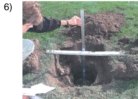
Infiltrationsmålingen startes. Der måles fra retningskinnen til vandoverfladen.
