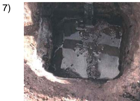
Der måles hvor langt vandet synker på 10 min.
