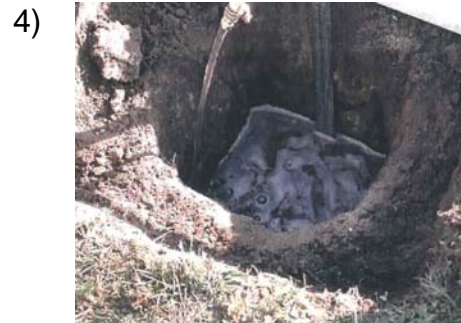
Hullet holdes fyldt med vand i ca. 30 min.
