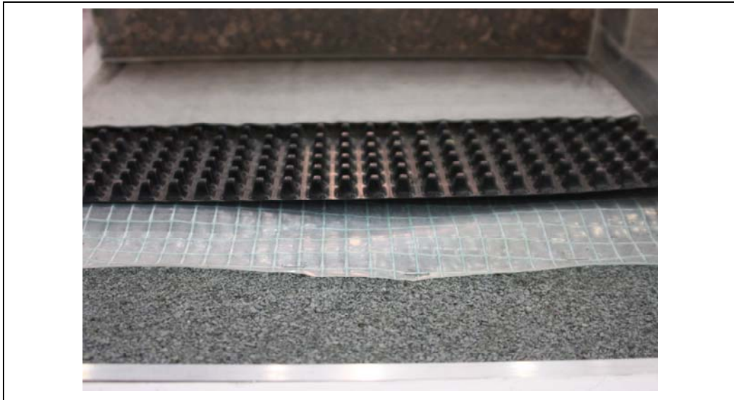
Figur 3.2 Eksempel på opbygning af drænlag
